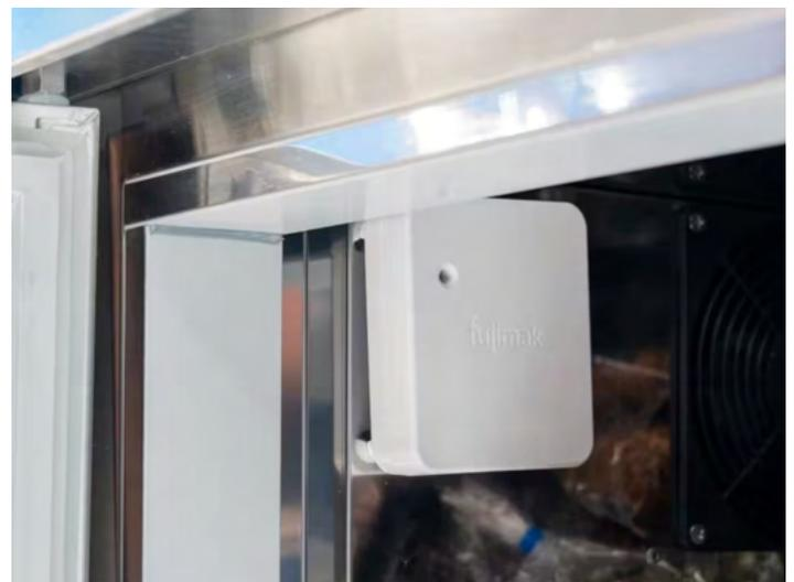
キッチンリンク・クラウドを導入し、多くの冷蔵庫・冷凍庫の温度変化を記録し、管理しています
