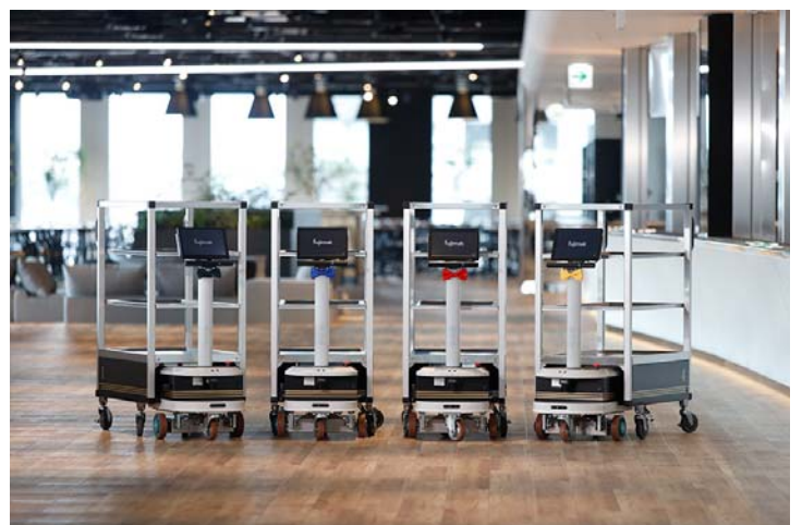
コンシェルジュをイメージした 4 台の自律移動搬送ワゴンが活躍しています。外形の樹脂成型の部分はいすゞ自動車様のデザインセンターがデザインしてくださいました
