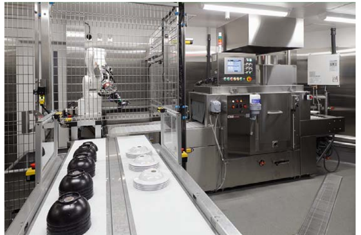
食器の自動仕分けロボット「finibo」。写真右の食器洗浄機から流れてきた洗浄済み食器をセンサーで認識し、糸底の水分を吹き飛ばしてからピックアップし、指定された方法で手前の回収コンベアに仕分けます
