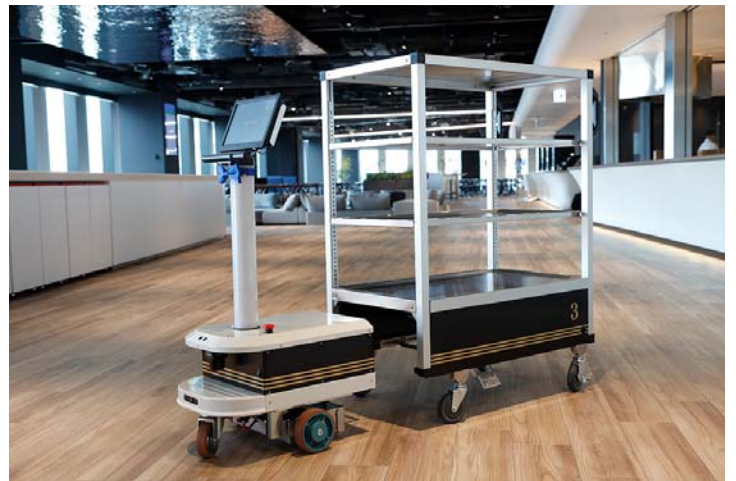
自律移動搬送ワゴン。タブレットで操作するロボット（写真左）が、ワゴン（写真右）をけん引。ロボットとワゴンは切り離しが可能です
